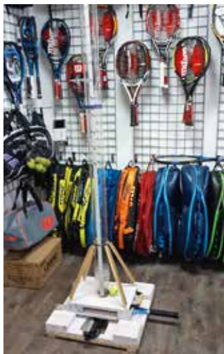
Фото 1. Установка для определения величины отскока теннисного мяча от струнной поверхности теннисной ракетки
