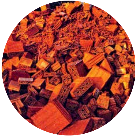
Исходный материал: грунтовая крошка изготавливается из битой черепицы и пористых кирпичей. Для ее производства важны два условия: низкая влажность и тепло
