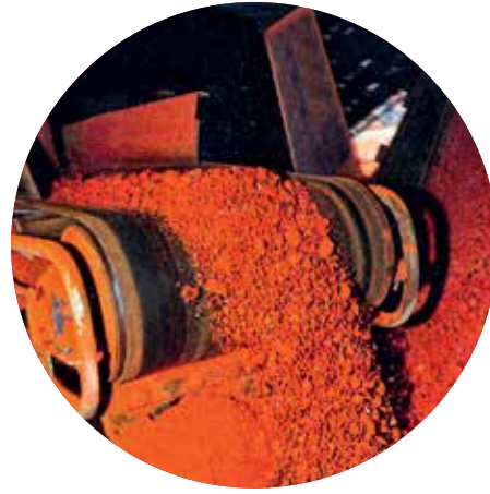
Дробилка: сырье поступает в машину. При этом важно, чтобы глина не подвергалась жесткому обжигу, чтобы грунтовая смесь на корте впитывала и удерживала достаточное количество влаги
