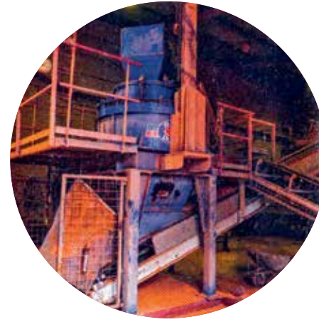
Мелкое дробление: смесь обрабатывается по непрерывной циклической схеме до достижения необходимой консистенции
