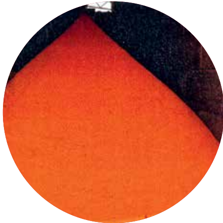
Так выглядит нужная консистенция грунтовой крошки, когда мелкие сита работают в нормальном режиме. Готовая смесь поступает по конвейерной ленте в складское помещение
